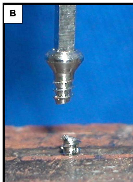
Figura 14: Parafuso fixado na prensa, com adaptação da chave do torquímetro, para realização do teste de resistência à torção(A), após a fratura do parafuso(B).
