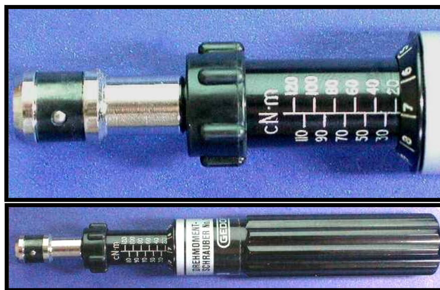
Figura 12: Torquímetro utilizado no teste de resistência à torção dos parafusos.
