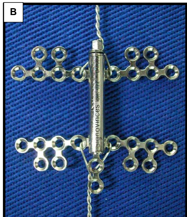
Figura 10: Deformação dos distratores da Conexão (A) e Signo Vinces (B), após o teste de resistência à tração.
