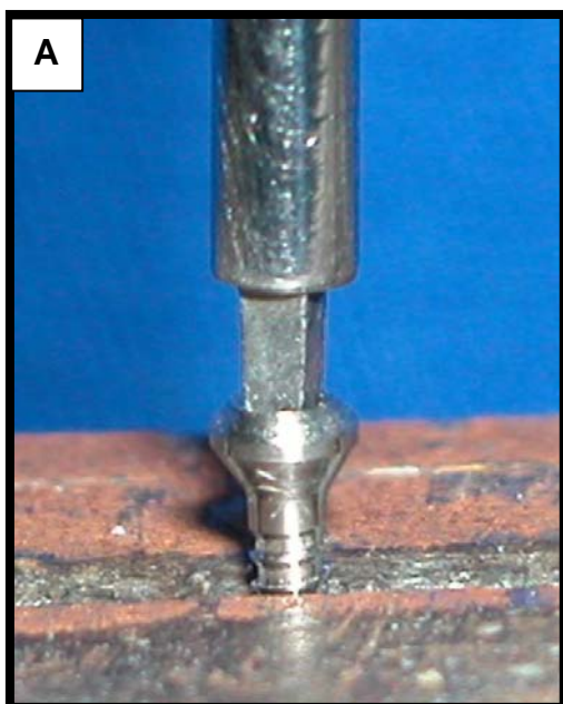
Figura 14: Parafuso fixado na prensa, com adaptação da chave do torquímetro, para realização do teste de resistência à torção(A), após a fratura do parafuso(B).
