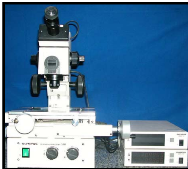
Figura 7: Microscópio medidor utilizado na tomada da medida II dos parafusos.
